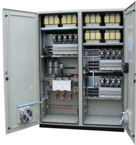
Automatycznie regulowana bateria KMD720R 400V (prod. ELMA energia) z dławikami (filtry odstrojone) f_r = 189\text{Hz} . Eksport do Holandii
